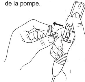
4. Utilisez le bouton de déclenchement pour déverrouiller le piston de la pompe. Pour ce faire, appuyez vers le bas sur la cale de verrouillage de la luge avec le bouton de déclenchement.
